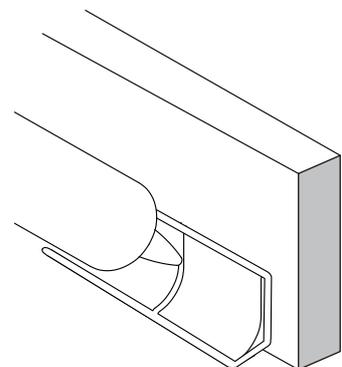
⚠ 隙間と突き合わせ（目地）部は必ずシールしてください。
