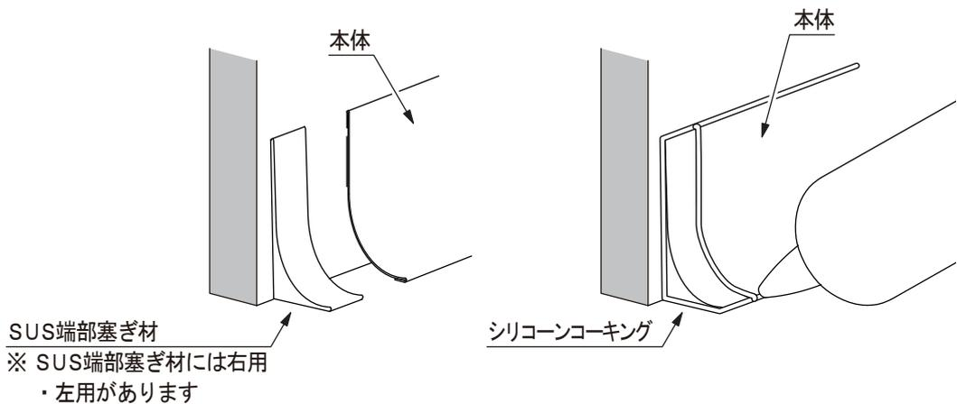
⚠ 端部キャップまたは端部塞ぎ材の取付けは必ずシリコンコーキング等でシールしてください。
