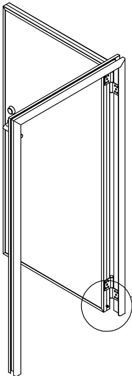
ドアが閉まるとノッチがドア枠に当たり、押されてボトムゴムが下に出てきます。
